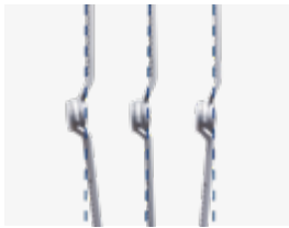
Articulation monocentrique pour l'abduction / adduction et la flexion / extension
